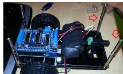
Pilars. Font pròpia
